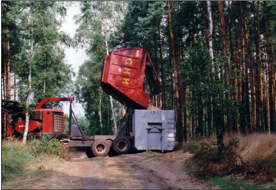
**Abbildung 8: Hackschnitzelharvester beim Umschütten seines Hackgutes**
